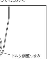
トルク調整つまみを押しながら回して、強さを設定します。目盛りの数字と三角形を合わせます。左図は目盛り3になります。
