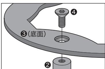
※台座裏面の2箇所のザグリ加工された穴を使用して、ボルト(山型)で固定して下さい。
