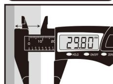
段差測定面をそれぞれ、被測定物の段差面上に真直ぐに押しかせて測定して下さい。
