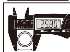
測定物を外側用測定面の中央で真直ぐに挟むようにして下さい。
