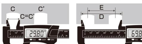
Cをまず測定し、その測定値をZEROスイッチを押します。
