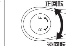
Fマークは正回転(締め付け時)、Rマークは逆回転(ゆるめる時)です。それぞれのFかRマークの矢印の方向に止まるまでしっかりと回してください。
