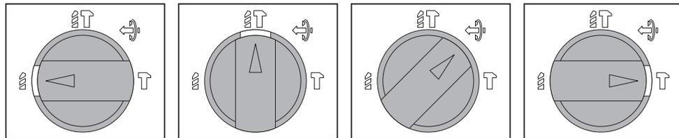
■回転モード ■回転+打撃モード ■打撃(破ツリ)用先端工具位置決め ■打撃モード(破ツリ)
