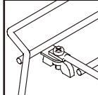
必ず蝶ネジの頭が内側になるように固定して下さい。
